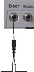
**Advertencia: No conecte el circuito de la cerradura directamente a los contactos de este relé.**
