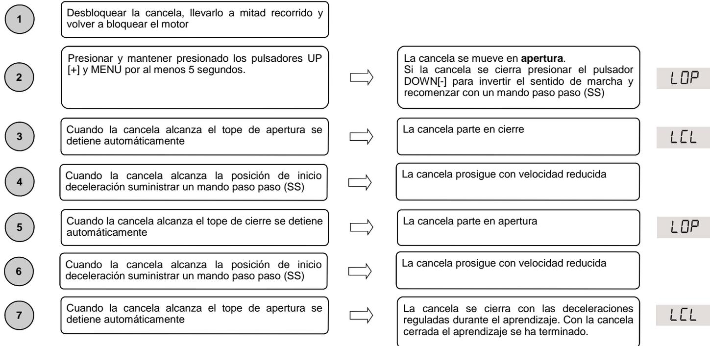
**Cuidado:** en el caso de intervención de un dispositivo de seguridad, el procedimiento se detiene y aparece en el display la palabra Presionar la tecla Paso Paso para iniciar nuevamente el aprendizaje desde el punto 2.
