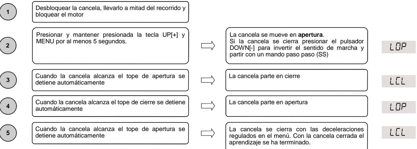
**Cuidado:** en el caso de intervención de un dispositivo de seguridad, el procedimiento se detiene y aparece en el display la palabra L--
